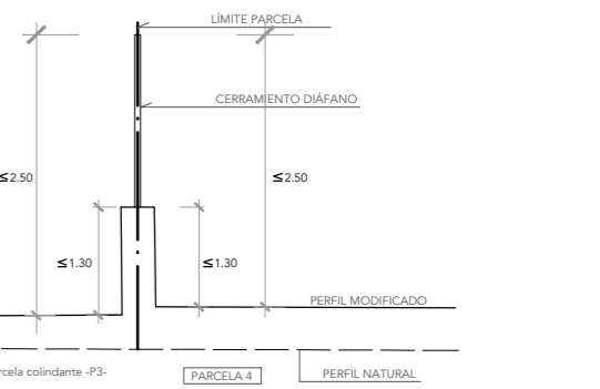
DETALLE MURO MEDIANERO P3 - P4 (B)
